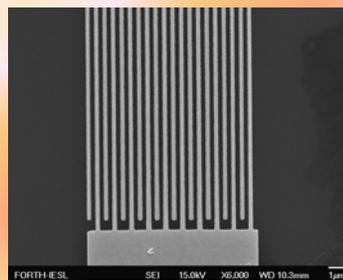
SAW test structure ( $W=250\text{nm}$ )
